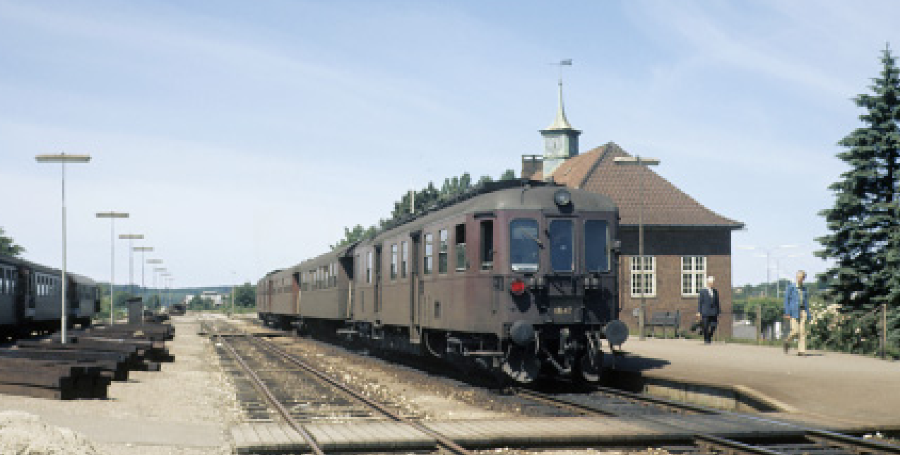
▲ På strækningen Ballerup-Frederikssund kørtes de fleste tog med en MO-motorvogn i hver ende og 2-3 CLL imellem, som hér i Frederikssund ca. 1966. (AK) ▼ Efter at S-banen blev forlænget fra Glostrup til Tåstrup i 1963, blev stationerne på fjernbanen mellem Valby og Roskilde (Glostrup, Tåstrup og Hedehusene) kun betjent af ganske få myldretidstog. Skulle man helt til Roskilde gik der til gengæld mere end 40 tog om dagen. Et persontog - måske fra Næstved-Køge - afgår fra Roskilde mod København ca. 1961. (OS)
